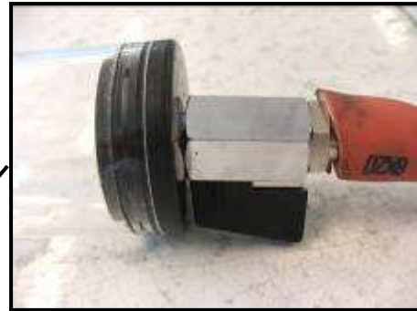
Valve permettant, une fois le vide fait dans le tube, de l'isoler
