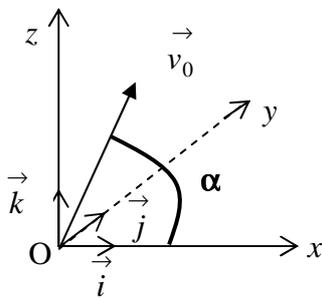
Un projectile de masse  $m$ , de centre d'inertie  $G$ , est lancé d'un point  $O$ , à un instant  $t = 0$ , avec une vitesse initiale  $\vec{v}_0$  faisant un angle  $\alpha$  avec l'horizontale. Les forces exercées par l'air sur le projectile sont négligeables devant le poids  $\vec{P}$ .
