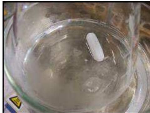
**Recrystallisation avec éthanol : sur plaque chauffante, dissolution totale du solide**
