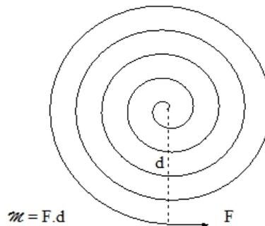
FIGURE 1 – Oscillateur de torsion et moment de force
