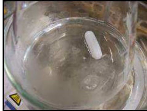
Recristallisation avec éthanol : sur plaque chauffante, dissolution totale du solide
