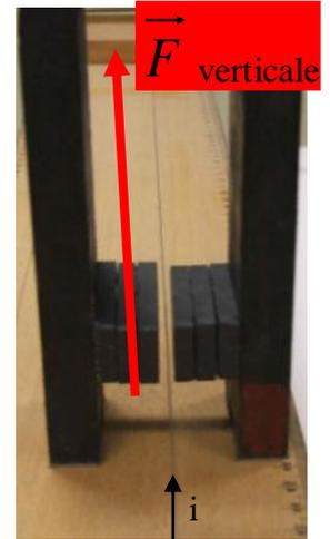
**La force de Laplace subit par la corde est verticale. Et comme le courant est alternatif, la force est alternativement dirigée vers le haut puis vers le bas ce qui provoque la vibration forcée de la corde**
