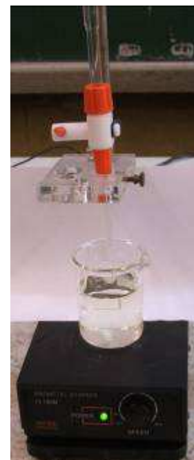
Montage de dosage
