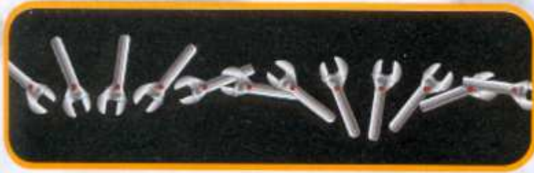
Doc. 4 Chronophotographie d'une clé à molette lancée sur une table à coussin d'air horizontale.
